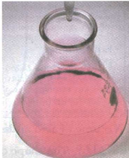
ΣΧΗΜΑ 5.2 Η φαινολοφθαλεΐνη είναι άχρωμη σε \text{pH} < 8,3 και κόκκινη σε \text{pH} > 10 .
