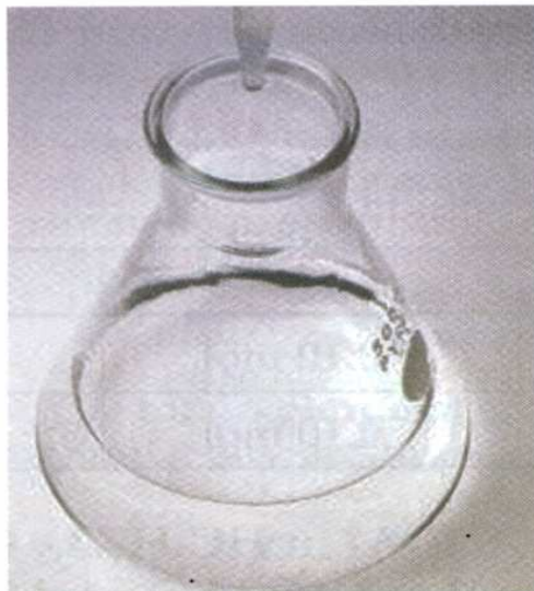
ΣΧΗΜΑ 5.2 Η φαινολοφθαλεΐνη είναι άχρωμη σε \text{pH} < 8,3 και κόκκινη σε \text{pH} > 10 .
