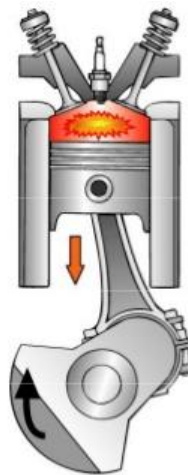
Το καύσιμο και ο αέρας συμπιέζονται και αναφλέγονται. Εκλύονται μεγάλα ποσά θερμότητας και τα θερμά καυσαέρια σπρώχνουν το πιστόνι προς τα κάτω. Η κίνηση αυτή μεταφέρεται τελικά στις ρόδες του οχήματος.
